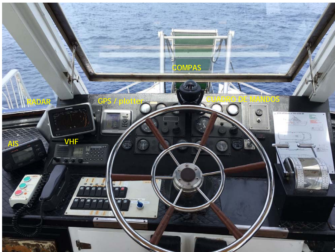
Figura 6. Puente de la E/P JOVEN ANTONIA SEGUNDO y disposición de los equipos tras la modificación a que se refiere el apartado 4.2
